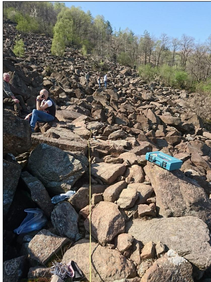
Stesura dei cavi geoelettrici sul boulder stream
