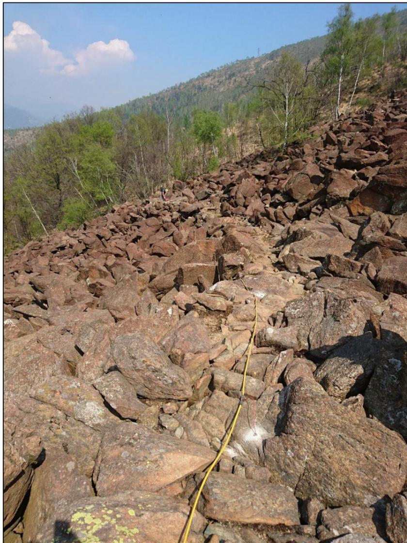
Stesura dei cavi sismici sul boulder stream
