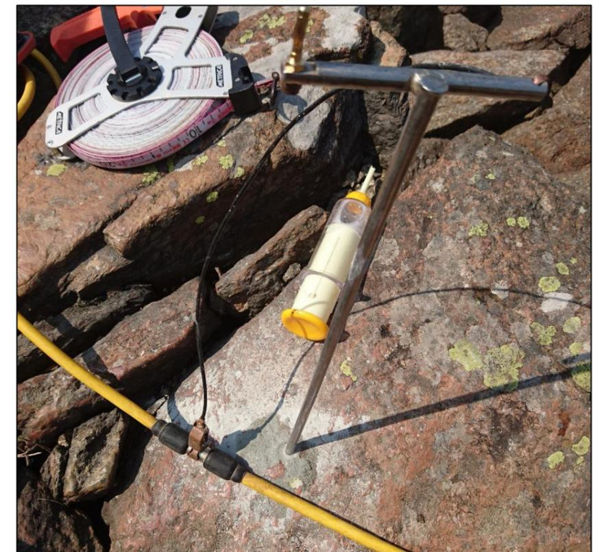
Abbassamento della resistività di contatto attraverso miscela salina
