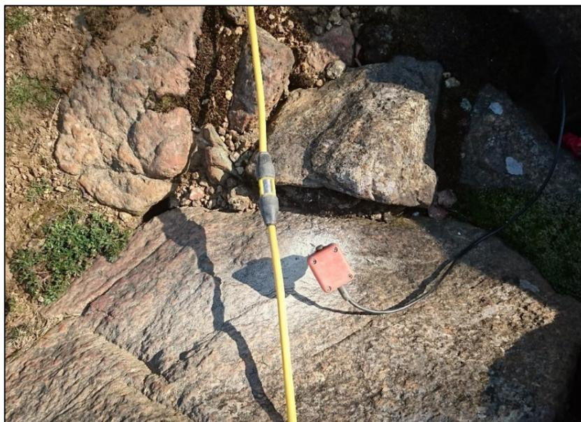
Posizionamento dei geofoni mediante preforo sui blocchi
